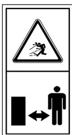
Du må ikke ferdes innenfor maskinens arbeidsområde. Kontrollér at underlaget som skal bearbeides er fri for stener, kviser og annet. Slikt vil kunne kastes ut fra maskinen og føre til skade på person og maskin. Unngå å kjøre over grusganger etc.
